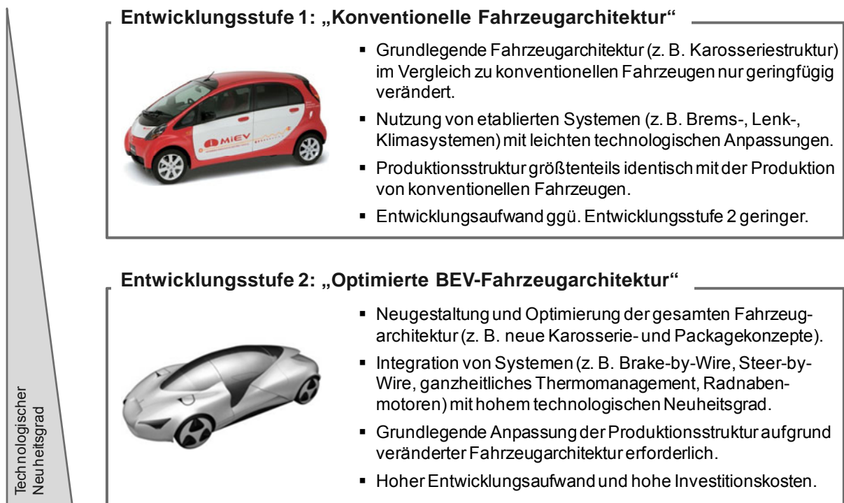
Abb. 4-16: Entwicklungsstufen von batteriebetriebenen Elektrofahrzeugen
