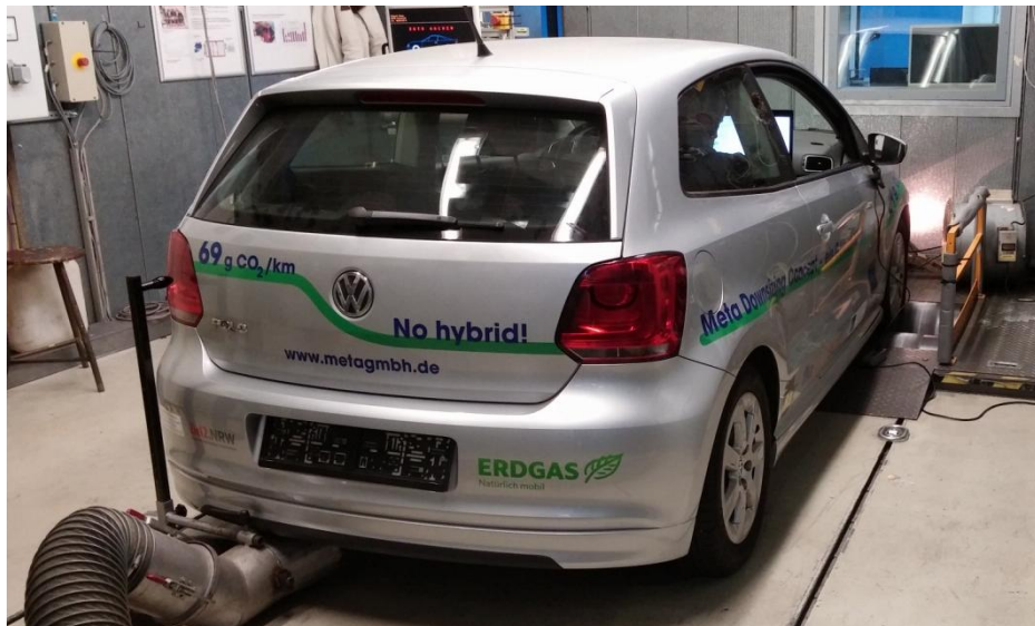
Abb. 3-28: Gerüstetes Demonstratorfahrzeug auf dem Rollenprüfstand am ika
