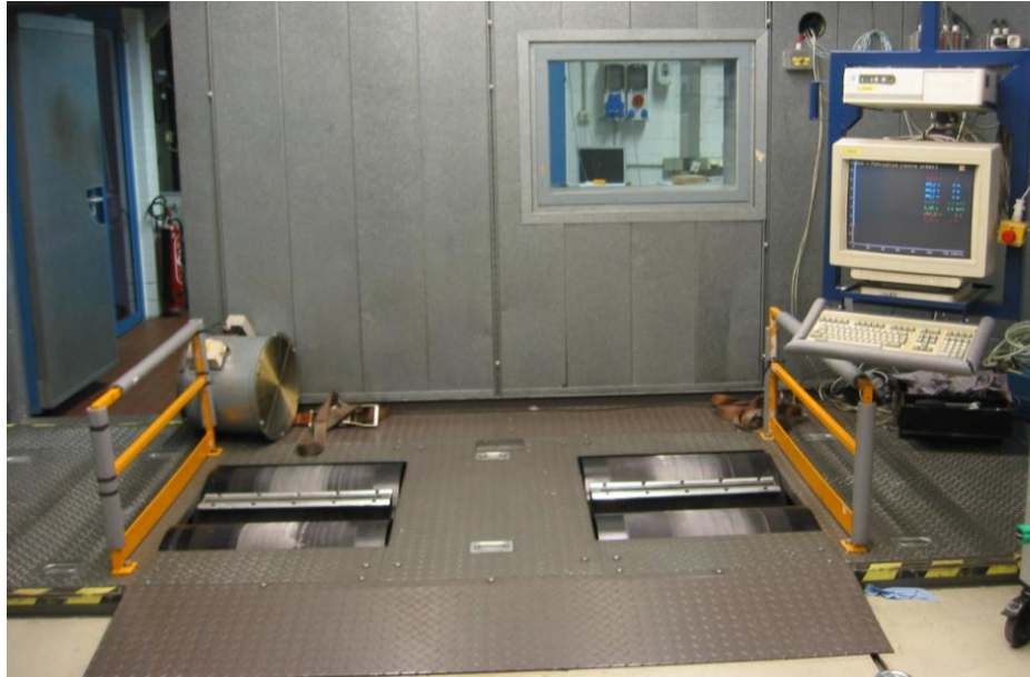
Abb. 3-27: Dynamischer Rollenprüfstand am ika für die Applikationsarbeiten
