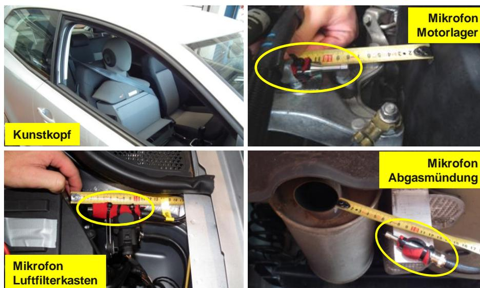
Abb. 3-17: Positionen zur Erfassung des Luftschalls
