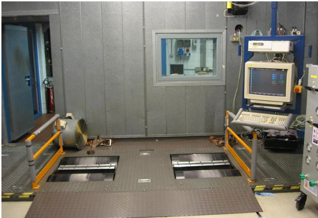
Abb. 3-1: Dynamischer Rollenprüfstand am ika
