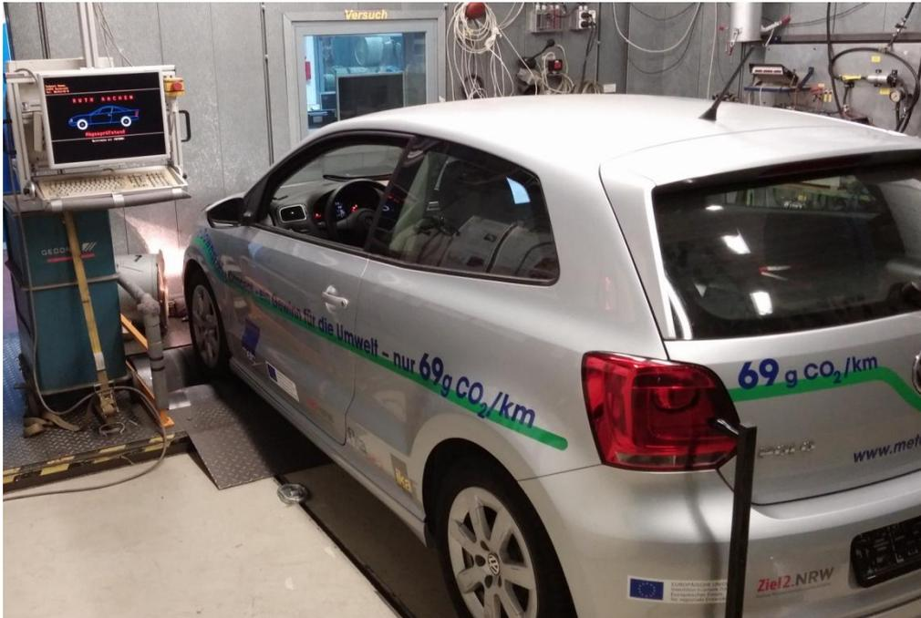
Abb. 3-73: Fahrzeug auf dem dynamischen Rollenprüfstand des ika (I)
