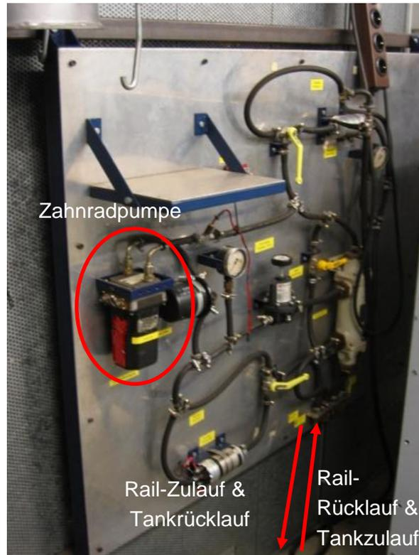
Abb. 3-10: Messeinrichtung am ika-Rollenprüfstand für den Kraftstoffdurchfluss
