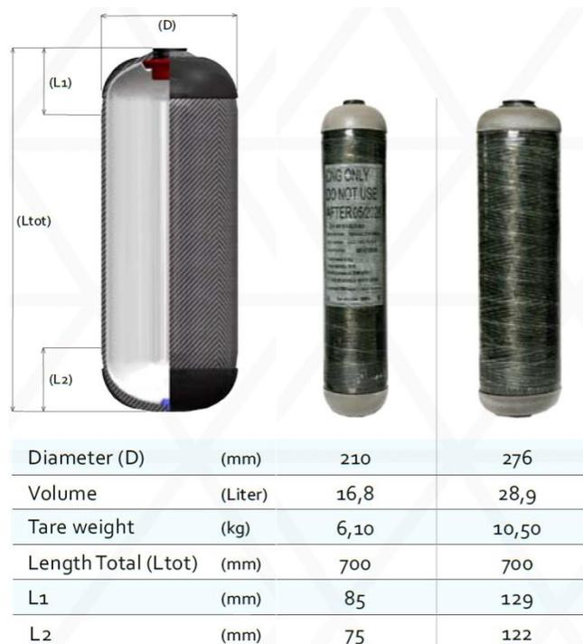
Abb. 3-28: Erdgastanks der Firma Hexagon (Typ 4) – technische Daten [HEX11]
