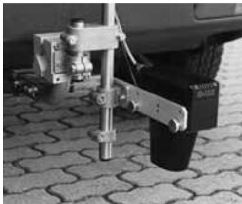
Abb. 3-4: Versuchsfahrzeug mit Geschwindigkeitssensor Correvit
