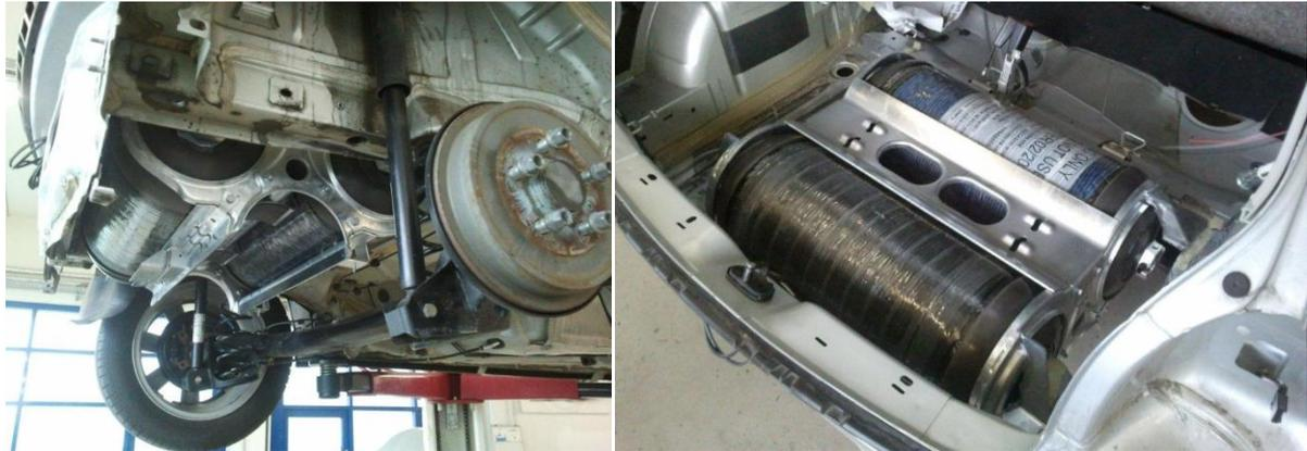
Abb. 3-66: Integriertes CNG-Tanksystem im Kofferraumbereich des Fahrzeugs
