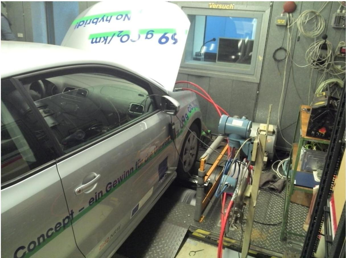
Abb. 3-84: Coriolis-Messsystem für den Erdgasdurchfluss am Rollenprüfstand
