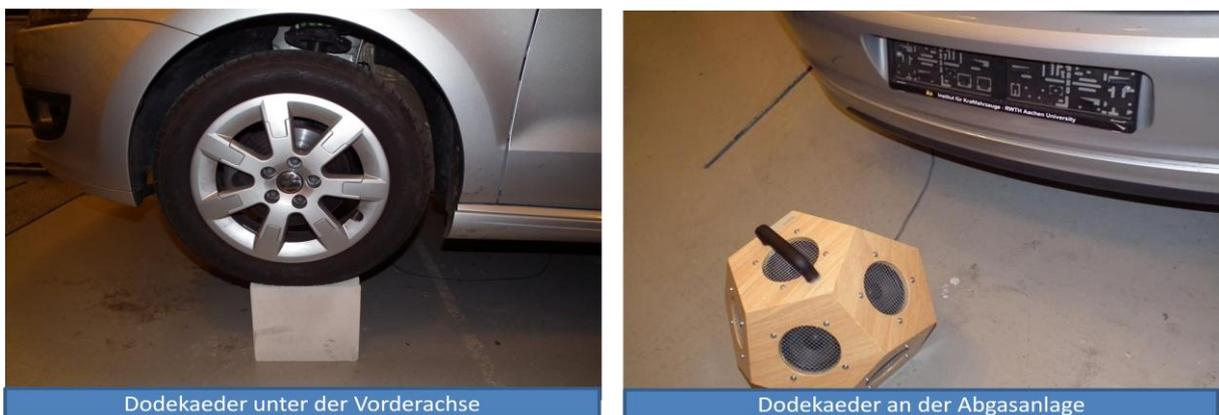
Abb. 3-22: Ermittlung der Luftschalltransferfunktion mittels Dodekaeder
