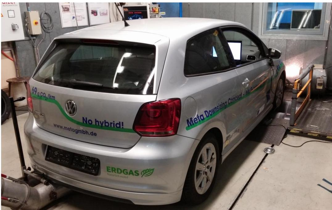
Abb. 3-8: Basisfahrzeug auf dem ika-Rollenprüfstand zur Verbrauchsbestimmung
